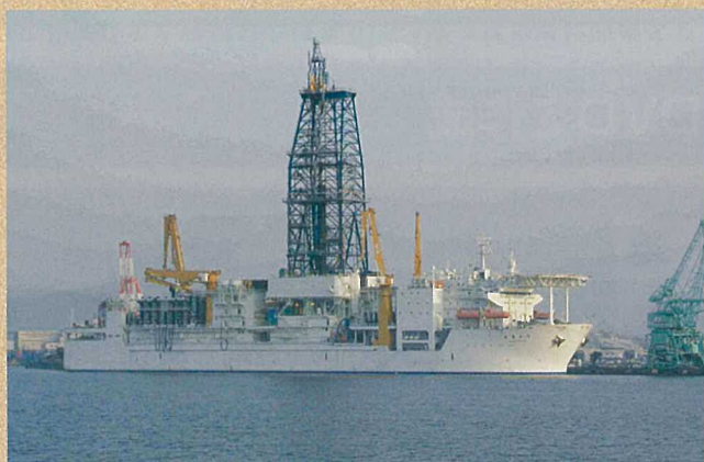
地球深部探査船「ちきゅう」（中央のやぐらが掘削用のデリック）
