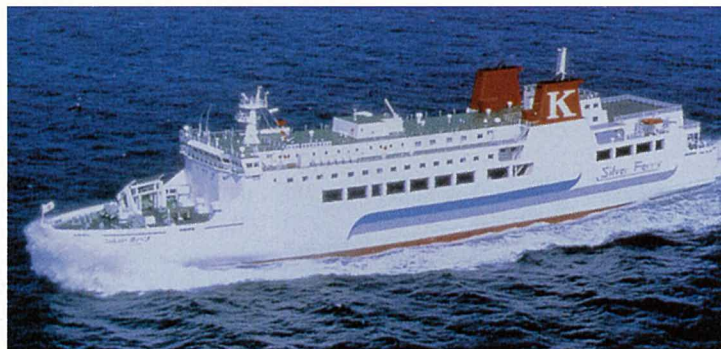
■総トン数/7,005t ■全長/134.0m ■最大速度/23.2ノット ■車両積載能力/トラック90台(9m換算)、乗用車20台 ■旅客定員/600名
